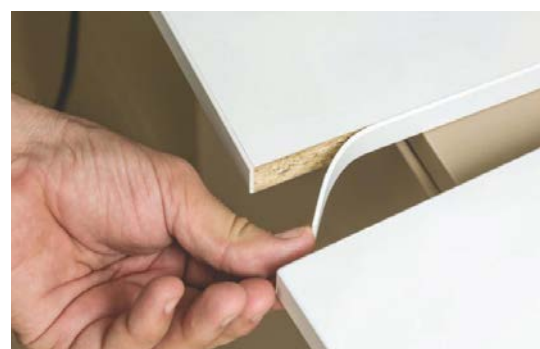
Odlepená hrana s lepidlom EVA
